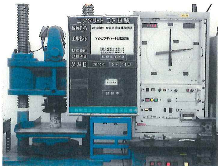
コンクリートコアの圧縮試験状況
